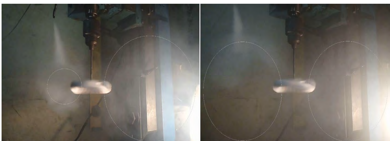
Рис. № 2. Визуализация торового распределения воздушных потоков.
