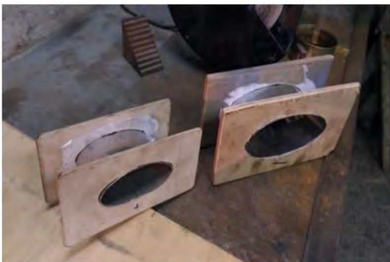
Рис. № 3. Варианты исполнения резонатора в форме эллиптического патрубка.
