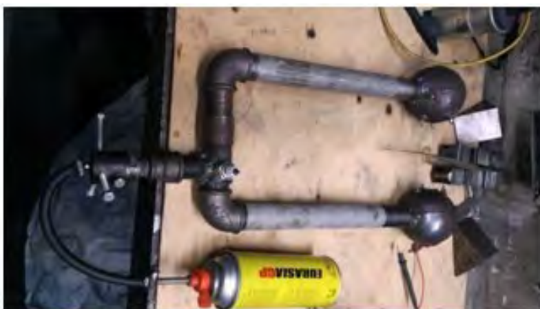
Рис. № 1. Стенд исследования детонационного схлопывания двух волн.
